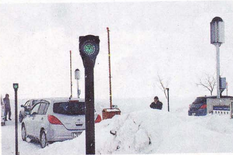
風力発電設備(右上)からの電力で緑色に点滅する誘導灯
