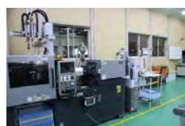
住友重機:SE30t 【除湿乾燥機取付】
